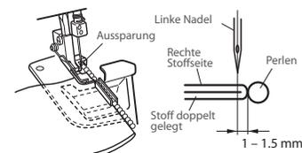
**Hinweis:** Werden die Perlen nicht gleichmäßig zugeführt, führen Sie die Perlen von Hand. Stellen Sie die Stichlänge so ein, dass eine Perle von einem Stich erfasst wird.
